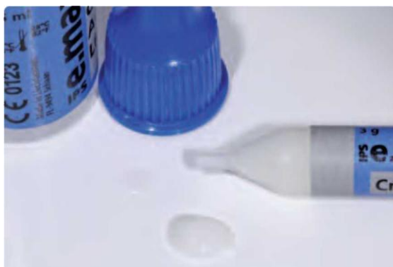
Glazurę w paście IPS e.max CAD Crystall./Glaze wycisnąć ze strzykawki i wymieszać. W razie potrzeby lekko rozcieńczyć płynem IPS e.max CAD Crystall./Glaze.
