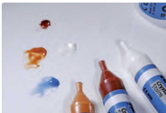
Masy IPS e.max CAD Crystall./Shades i Stains wycisnąć ze strzykawki i wymieszać. W razie potrzeby rozcieńczyć płynem IPS e.max CAD Crystall./Glaze.
