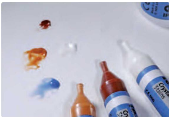
IPS e.max CAD Crystall./Shades i Stains wycisnąć ze strzykawki i wymieszać. W razie potrzeby rozcieńczyć płynem IPS e.max CAD Crystall./Glaze.
