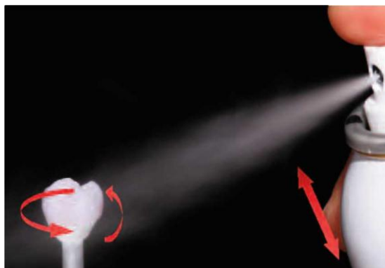
Spryskać glazurą w spray’u IPS e.max CAD Crystall./Glaze bezpośrednio niewypalone masy IPS e.max CAD Crystall./Shades i Stains. Uzupełnienie spryskać z każdej strony, jednocześnie je obracając.
