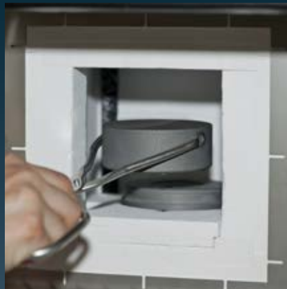
5 Zamknięta puszka do synteryzacji przenoszona jest do pieca
