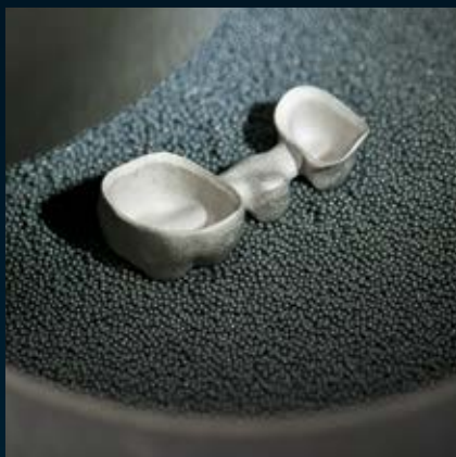
7 Uzupełnienie Ceramill Sintron po syntezyacji oraz po wyjęciu z pieca syntezyacyjnego Ceramill Argotherm
