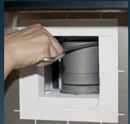
6 Położenie pokrywy i uruchomienie procesu synteryzacji
