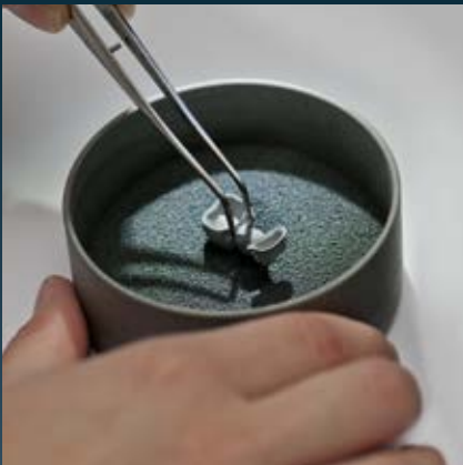
4 Umieszczenie uzupełnienia w puszcze synteryzacyjnej pieca Argovent
